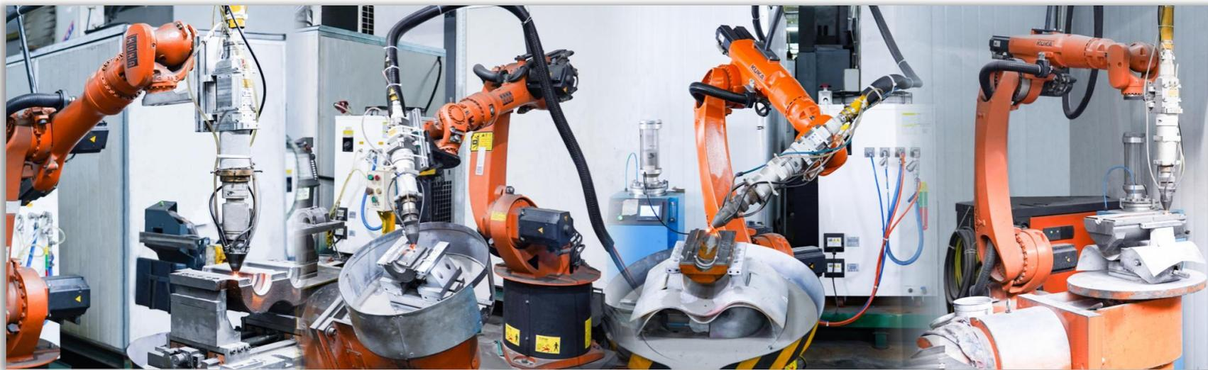
Лазерная наплавка чугунных и бронзовых форм и горловых колец позволяет сделать упрочняющий слой абсолютно ровным и практически исключить растрескивание и отслоение наплавки, достигая при этом экономии никелевого порошка до 30%. Сейчас у компании 12 роботизированных лазерных автоматов.
