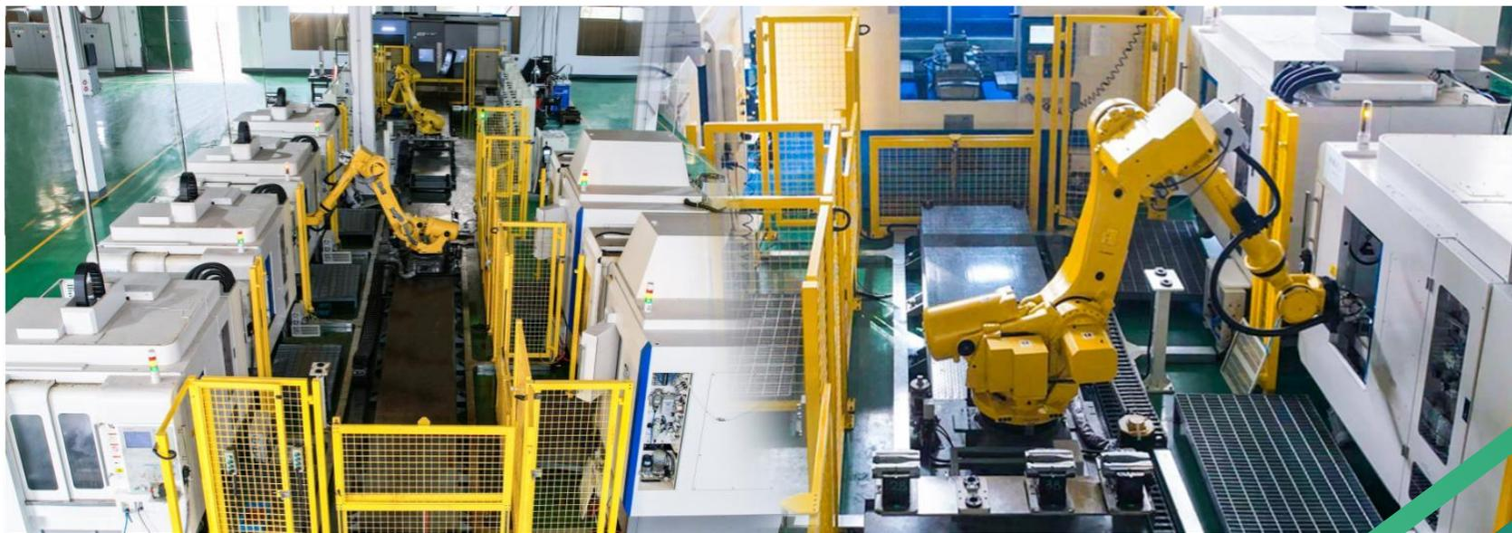
Автоматические линии, работающие по методу «U-share» выполняют весь цикл производства форм от литейной заготовки до готовой формы на одной линии. Производство осуществляется 24 часа 7 дней в неделю.
