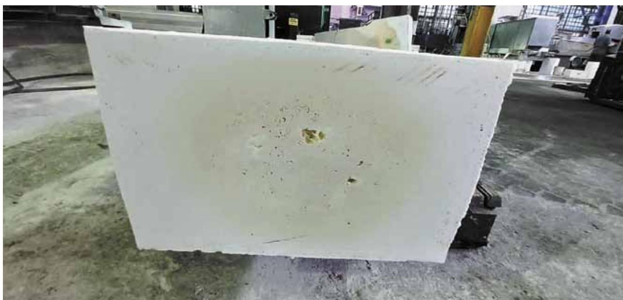
РИС. 2. Линия реза изделия под прибыльной частью с остаточной (редуцированной) усадочной раковинной.
