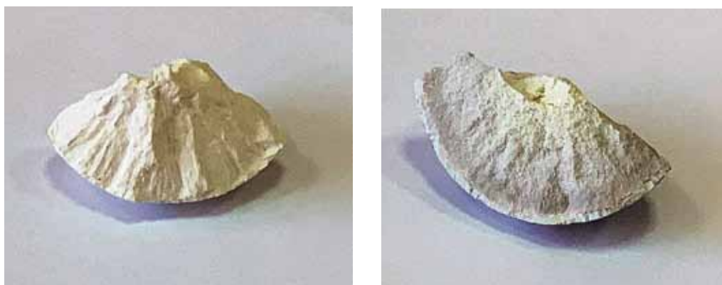
РИС. 1. Фрагменты отбираемых образцов (сверху оксидированный, снизу не оксидированный).
