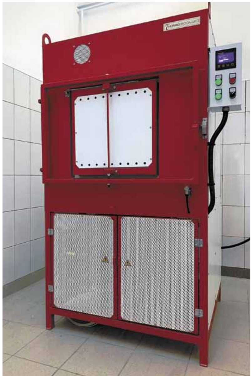
РИС. 4. Высокотемпературная печь для исследования свойств багора. →
