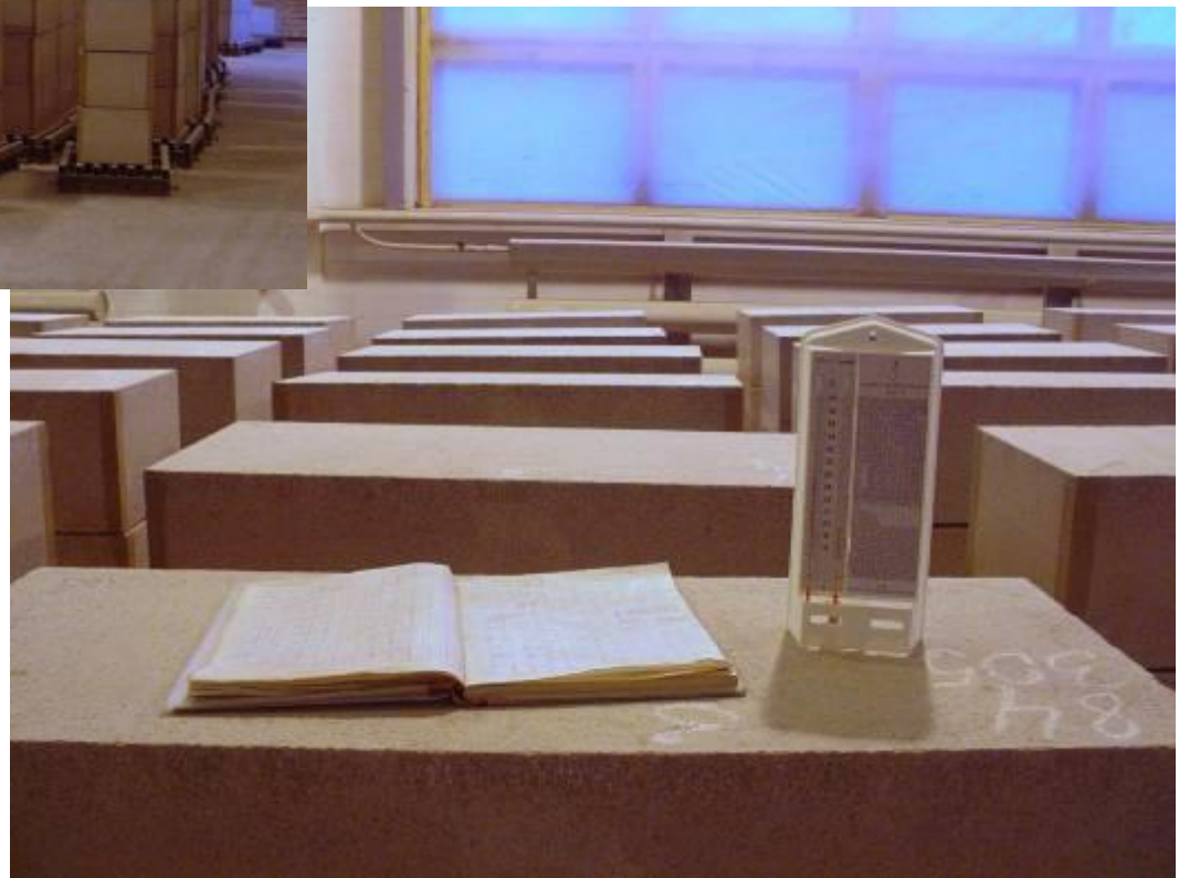
Контроль сушки сырца в помещении
