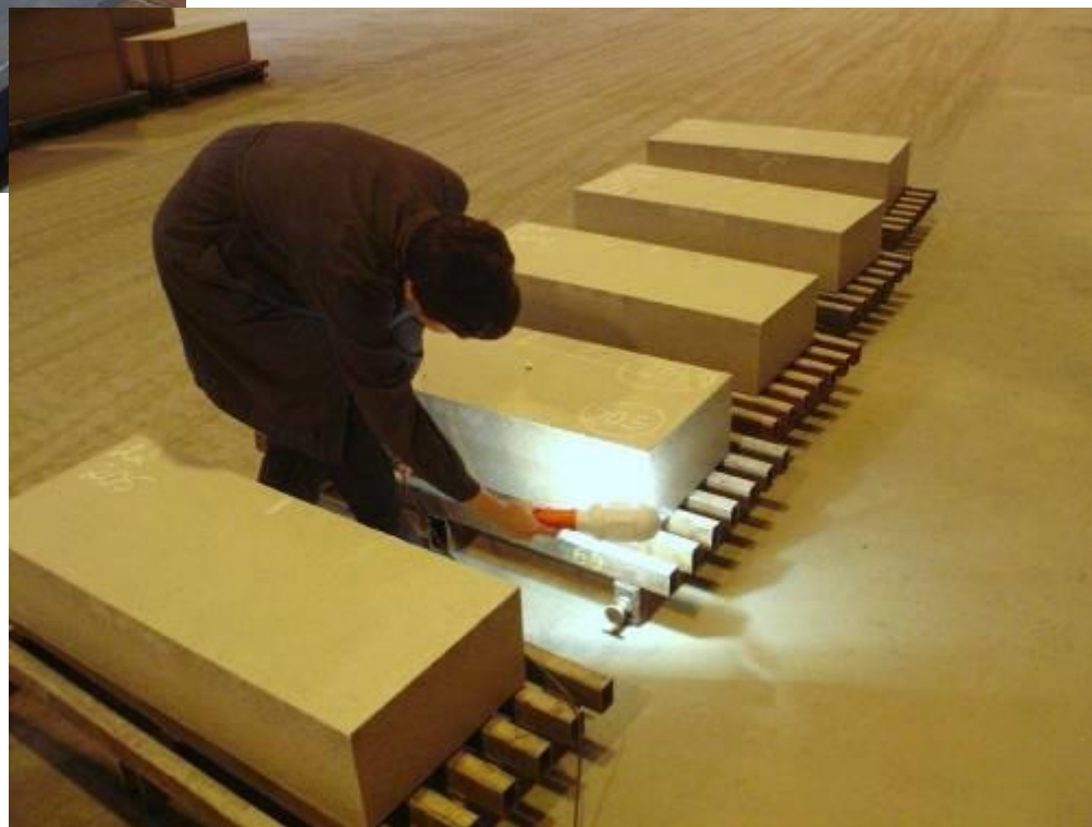
Визуальный контроль сырца на наличие трещин
