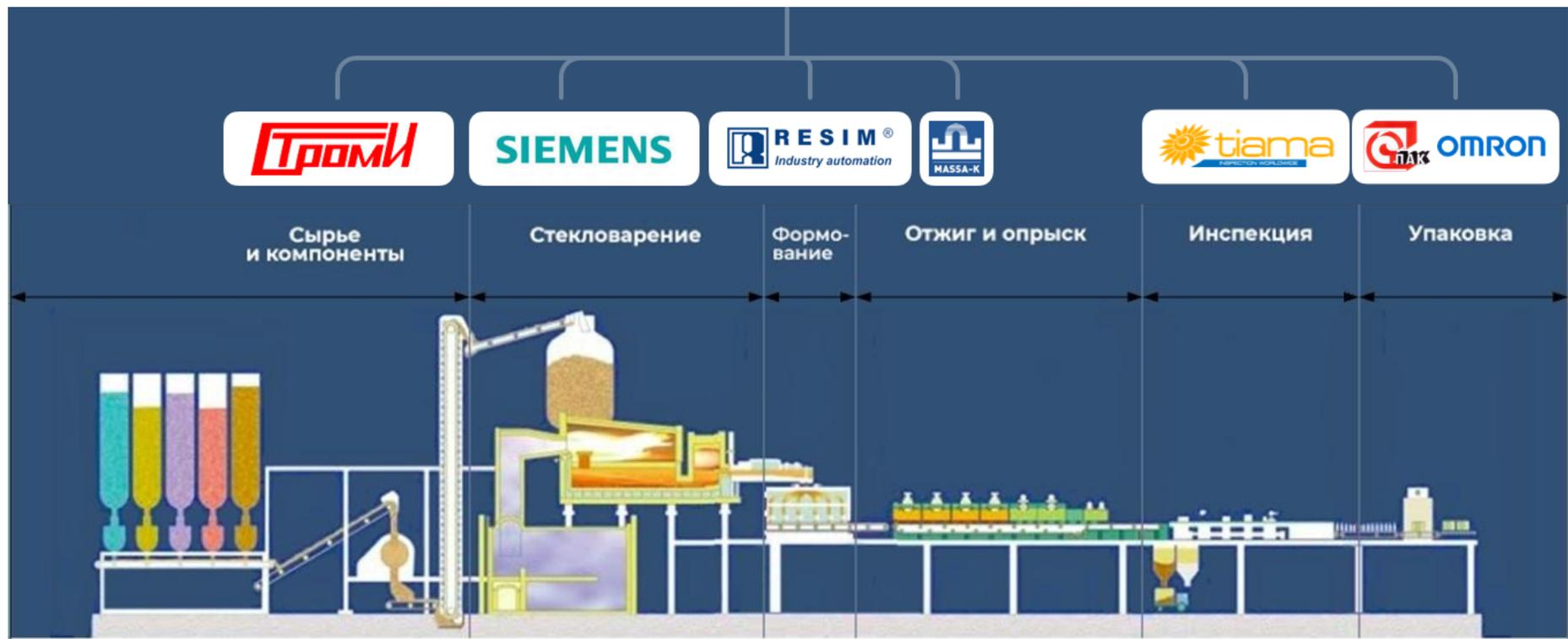
Особенностью производства изделий из стекла, является то, что это конвейерное безостановочное производство. После запуска печи, линия работает в непрерывном режиме в течение всего срока жизни печи.
