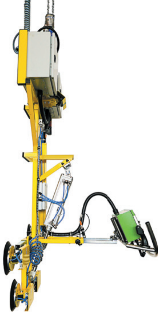
РИС. 2. Строжайший из стандартов безопасности наших клиентов был интегрирован в конструкцию V-H 150. На практике это означает, что встроенный контроллер безопасности постоянно контролирует весь рабочий цикл — от подъема, перемещения и наклона до установки стекла.
