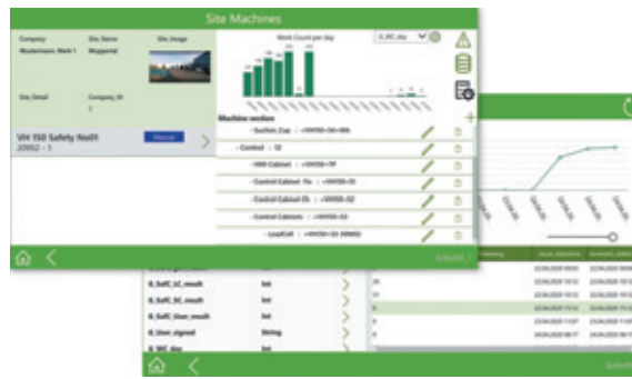
РИС. 3. Интеграция IoT-совместимого V-H 150 в Hegla Shopfloor Assistant. Доступ ко всей производственной статистике устройства, KPI, параметрам, руководствам, технической документации, интервалам техобслуживания и результатам проверки безопасности можно получить в любое время с помощью ПК или мобильного устройства.
