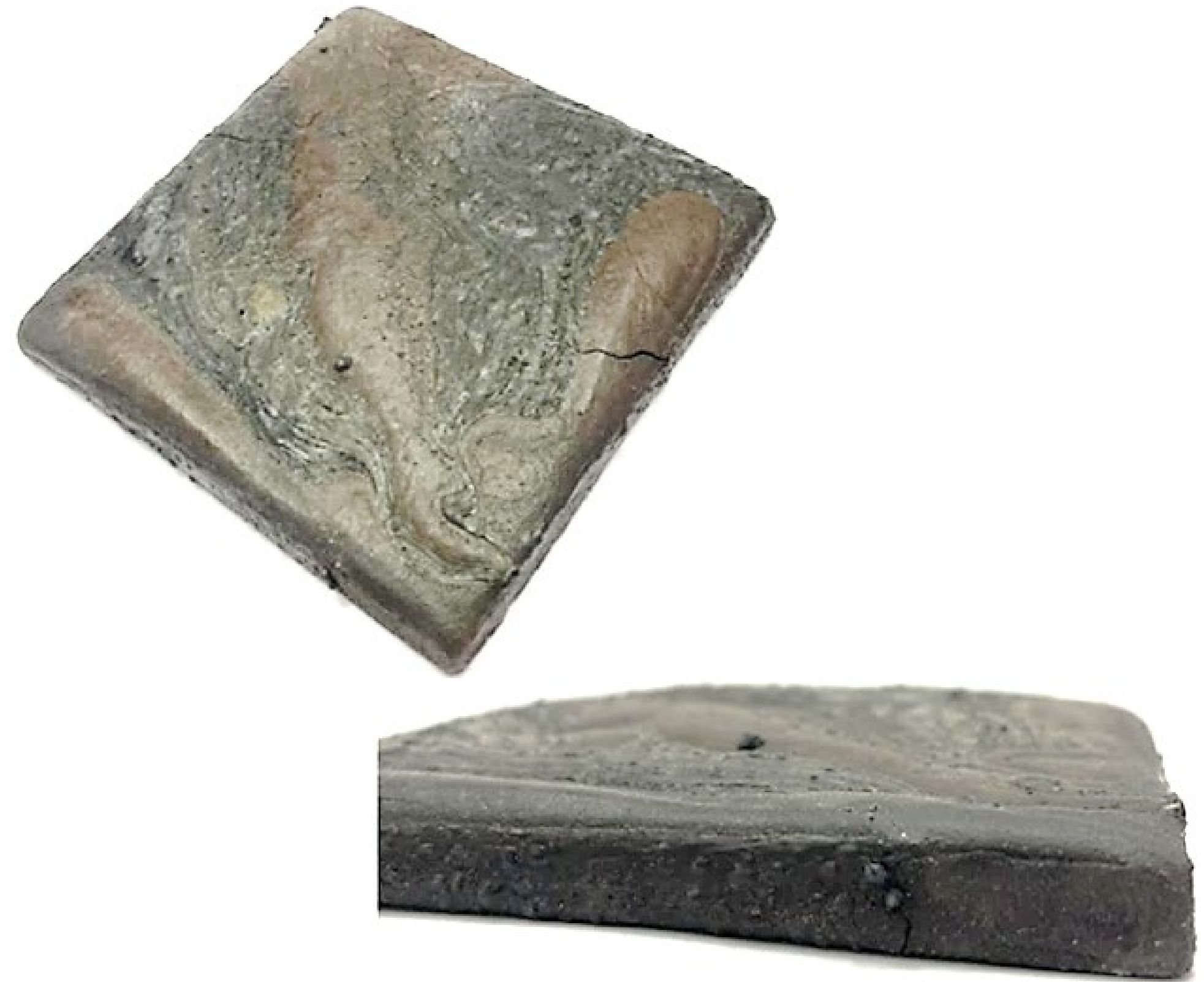
Сформованная плитка шлакоситалла состава №6 после двуступенчатой кристаллизации
