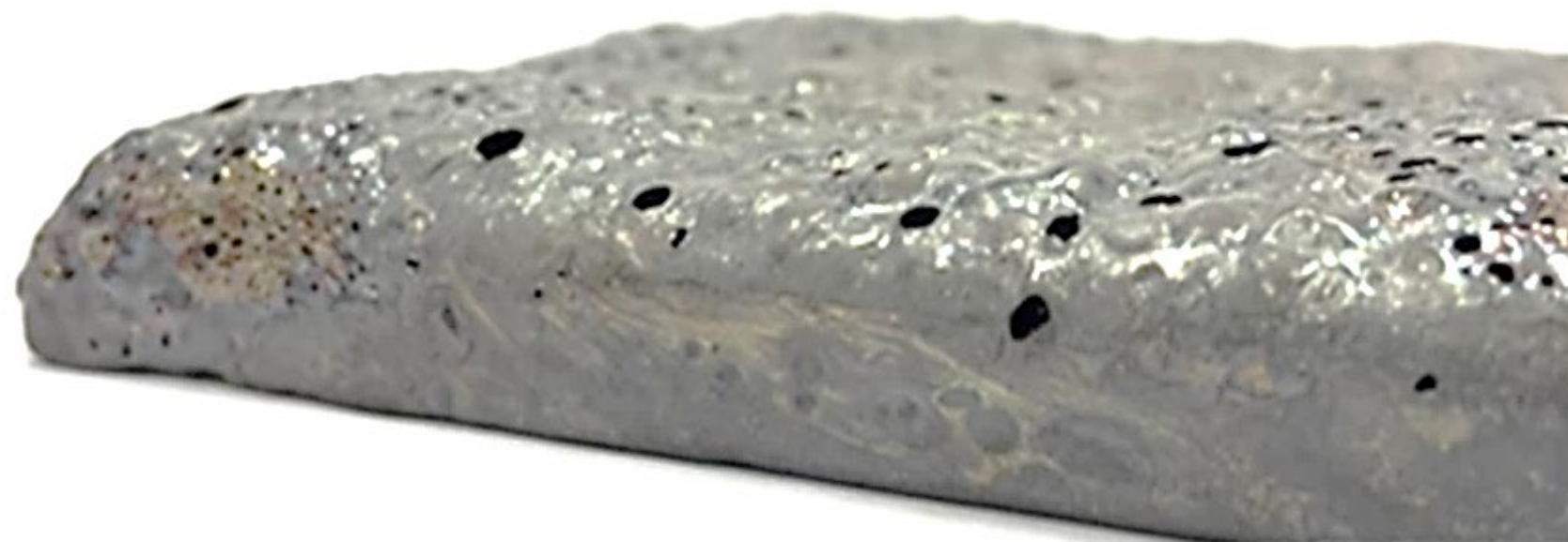
Сформованная плитка шлакоситалла состава №5 после двуступенчатой кристаллизации
