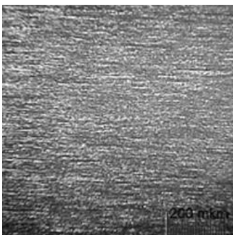
В-МП лист толщиной 1 мм, x100, плотность материала 19,21 г/см 3 , твердость HRC 46
