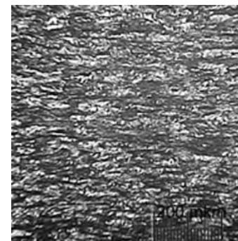
В-МП пластина толщиной 8 мм, x100, плотность материала 19,25 г/см 3 , твердость HRC 43
