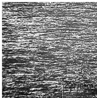
В-МП лист толщиной 5 мм, x100, плотность материала 19,25 г/см 3 , твердость HRC 44
