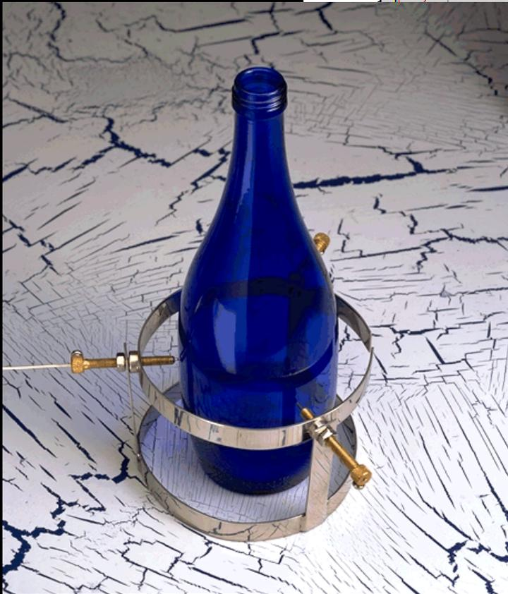
Однородность температуры отжига керамических эмалей декорирующих элементов на бутылке очень важна. При этом изделия поступают на лер печи от нескольких формовочных машин и на входе в печь имеют различную температуру
