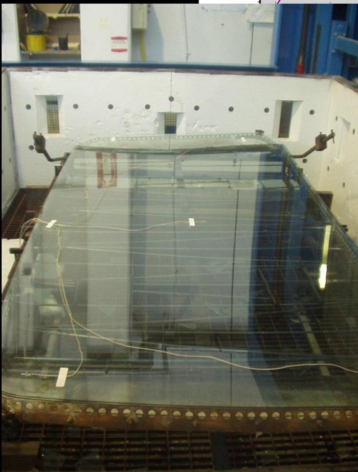
Система мониторинга на формообразователе Датчики в стеклонити крепятся с помощью керамической пасты и термостойкой ленты.
