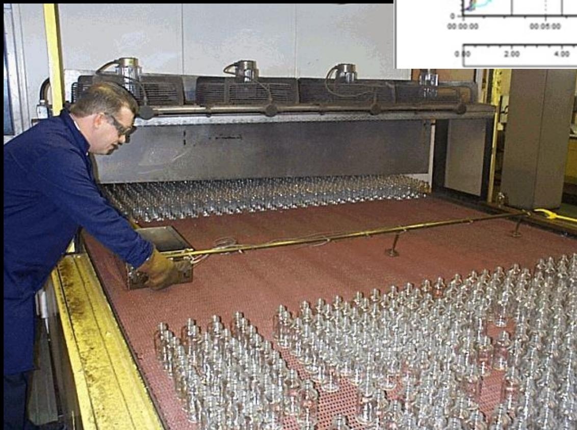
Система с телескопической планкой для измерения температуры по ширине лера. Подобная система отгружена в ноябре 2022 года в ООО «Экспо Гласс» (г. Гусь-Хрустальный)
