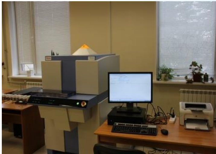
Рентгенофлуоресцентный спектрометр серии ARL 9900 WorkStation с встроенной системой дифракции
