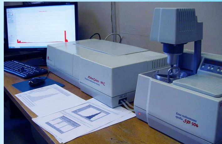
Лазерный анализатор размеров частиц Микросайзер 201 гранулометрический анализ порошковых материалов, суспензий и эмульсий
