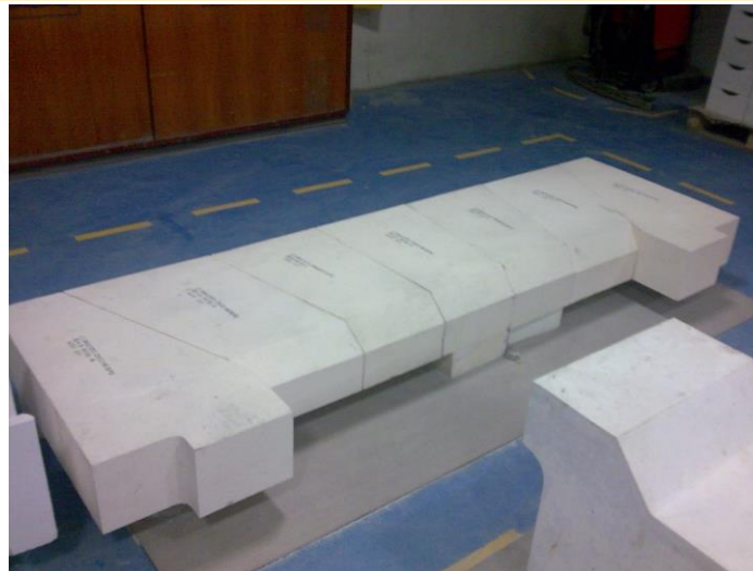
Вспомогательная арка загрузочного кармана
