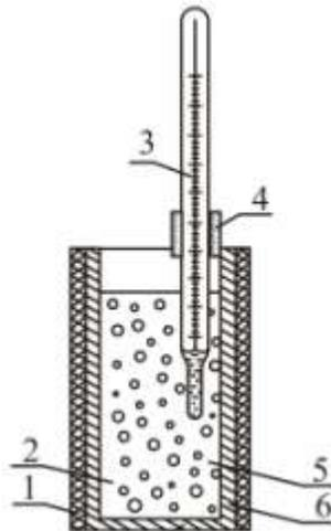
*1 – теплоизоляция; 2 – ацетон или изопропиловый спирт; 3 – термометр; 4 – держатель; 5 – твердая двуокись углерода; 6 – корпус*
